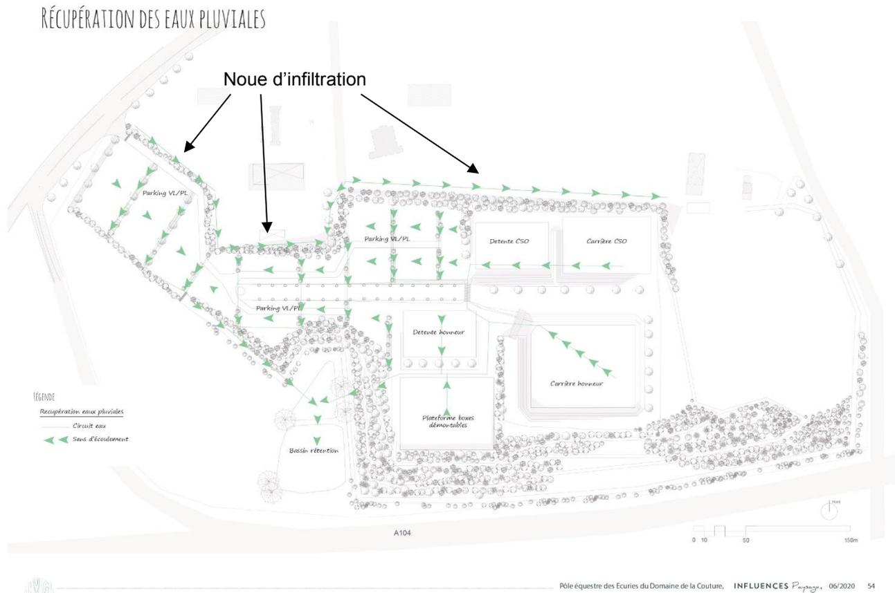
Cette noue d'infiltration sera localisée dans la bande des 10 m, hors stockage de remblais.
